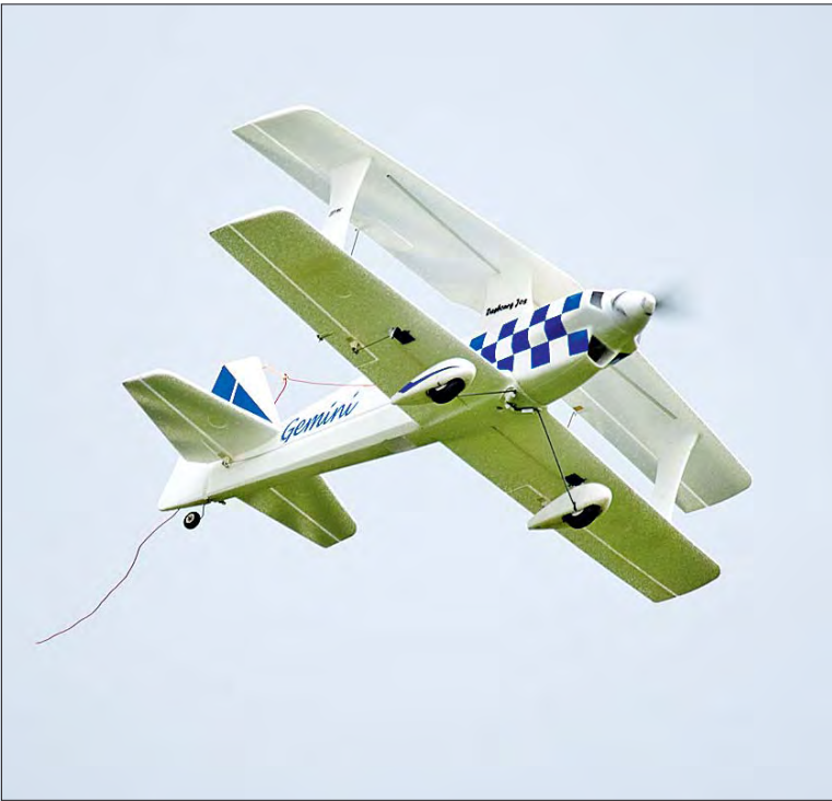
Dieser ferngesteuerte Elektro-Doppeldecker aus Styropor-ähnlichem Elapor wiegt startfertig weniger als ein Kilogramm.
